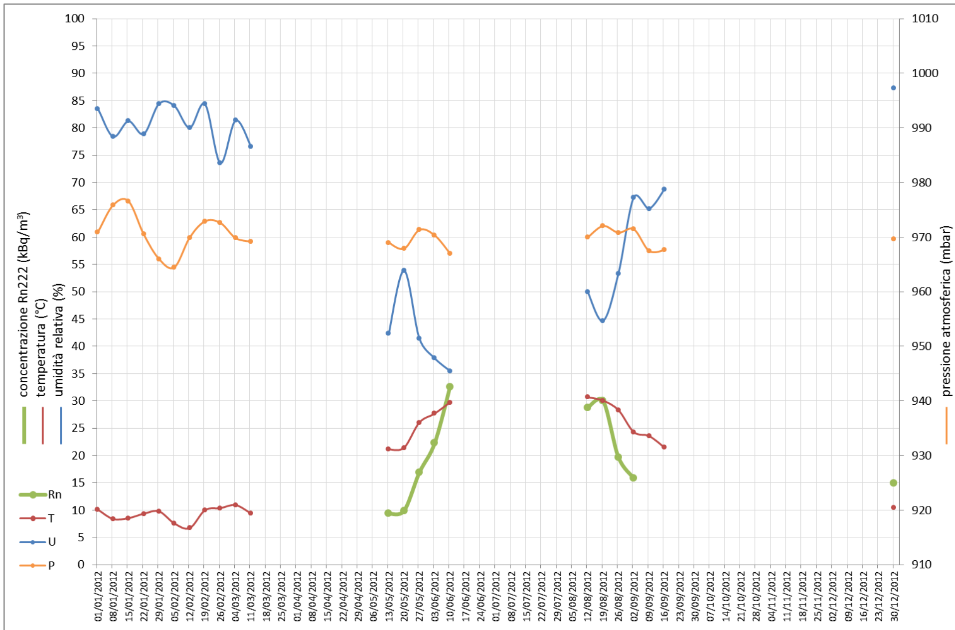
Figura 5 – Grafico dei valori mensili medi di concentrazione di radon, temperatura, umidità relativa e pressione atmosferica registrati dalla stazione di rilevamento di Modica nell’anno 2012.
