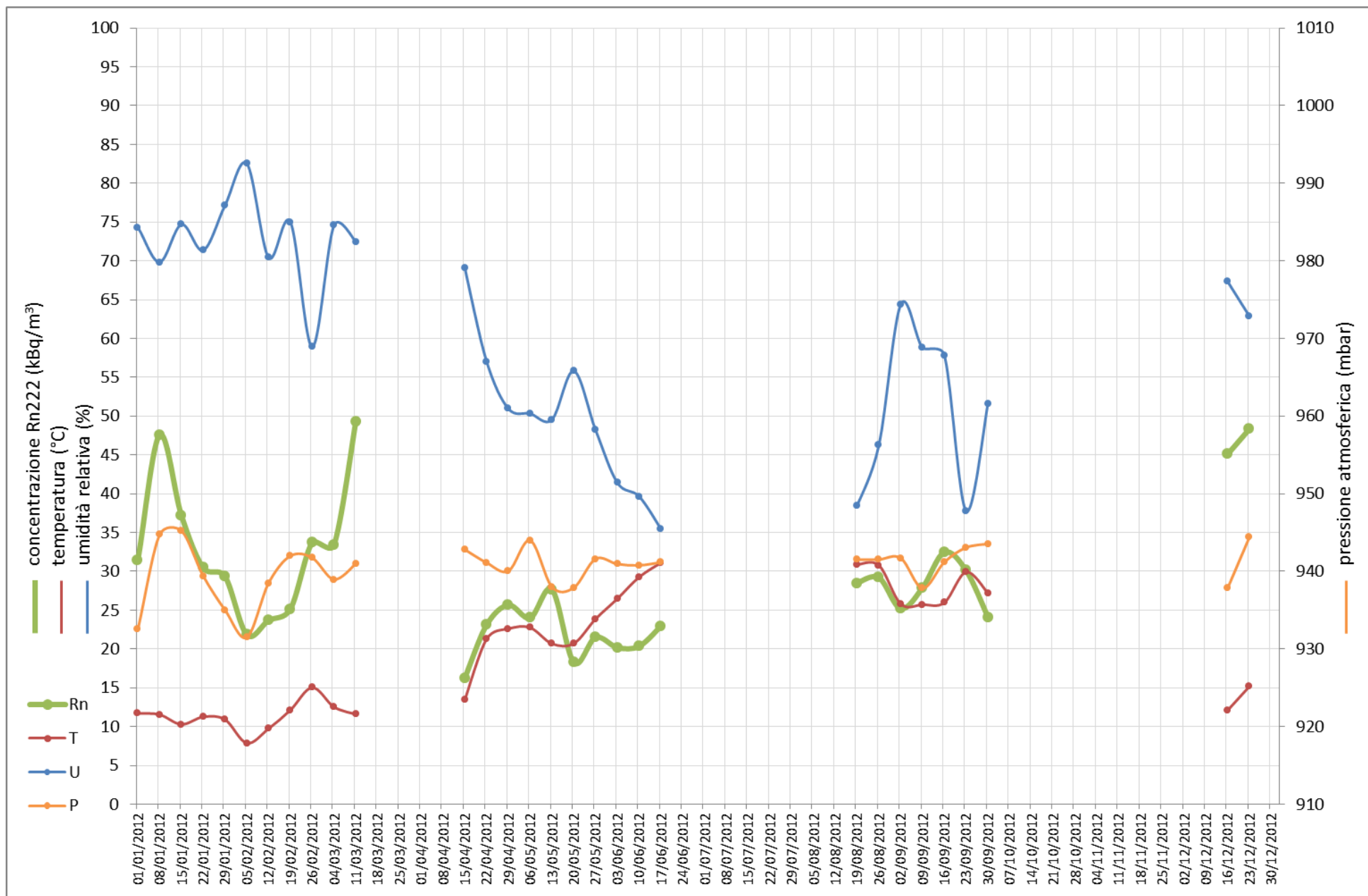
Figura 3 – Grafico dei valori settimanali medi di concentrazione di radon, temperatura, umidità relativa e pressione atmosferica registrati dalla stazione di rilevamento di Monterosso Almo nell'anno 2012.
