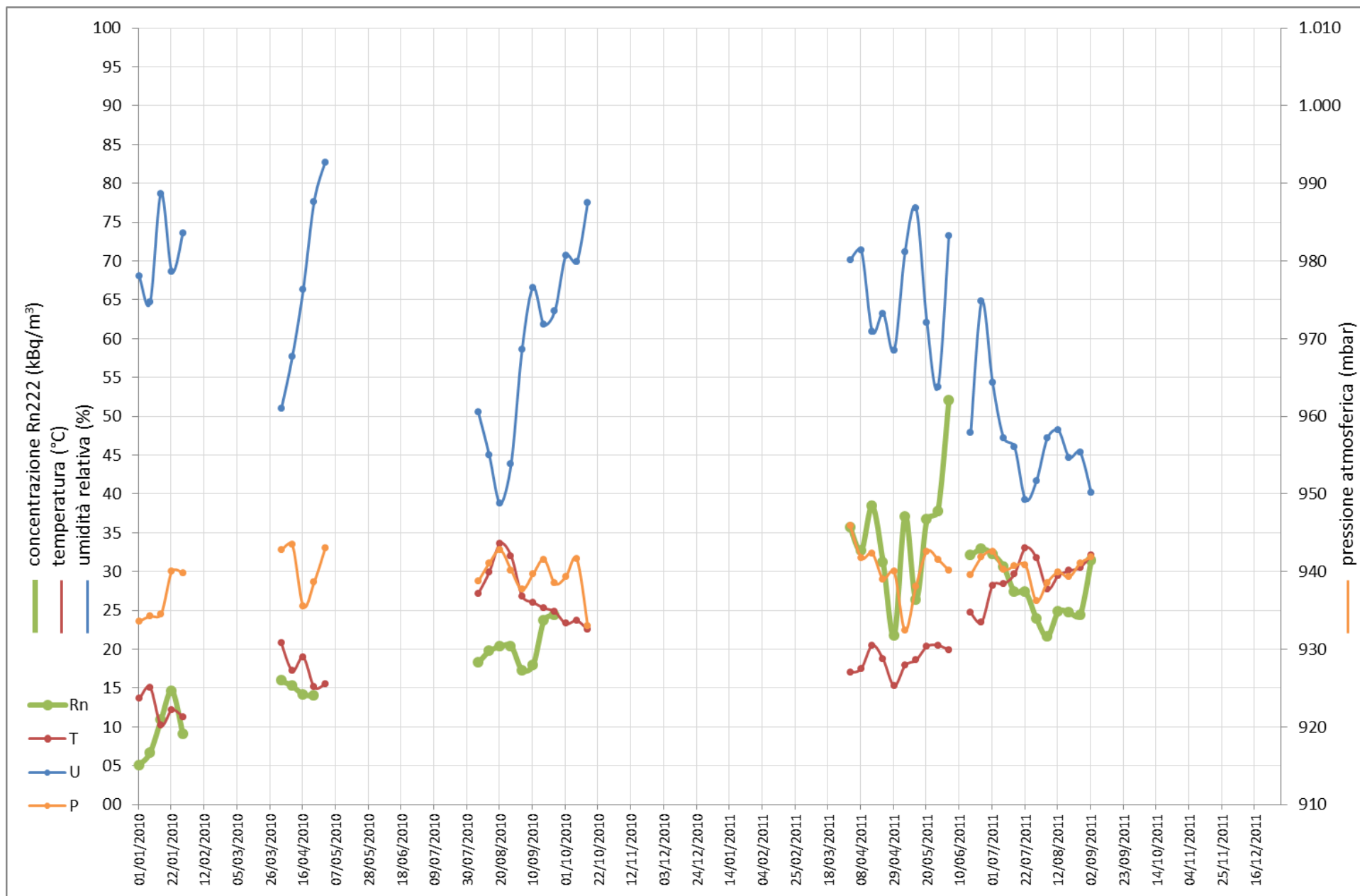
Figura 3 – Grafico dei valori settimanali medi di concentrazione di radon, temperatura, umidità relativa e pressione atmosferica registrati dalla stazione di rilevamento di Monterosso Almo nel periodo 2010-2011.
