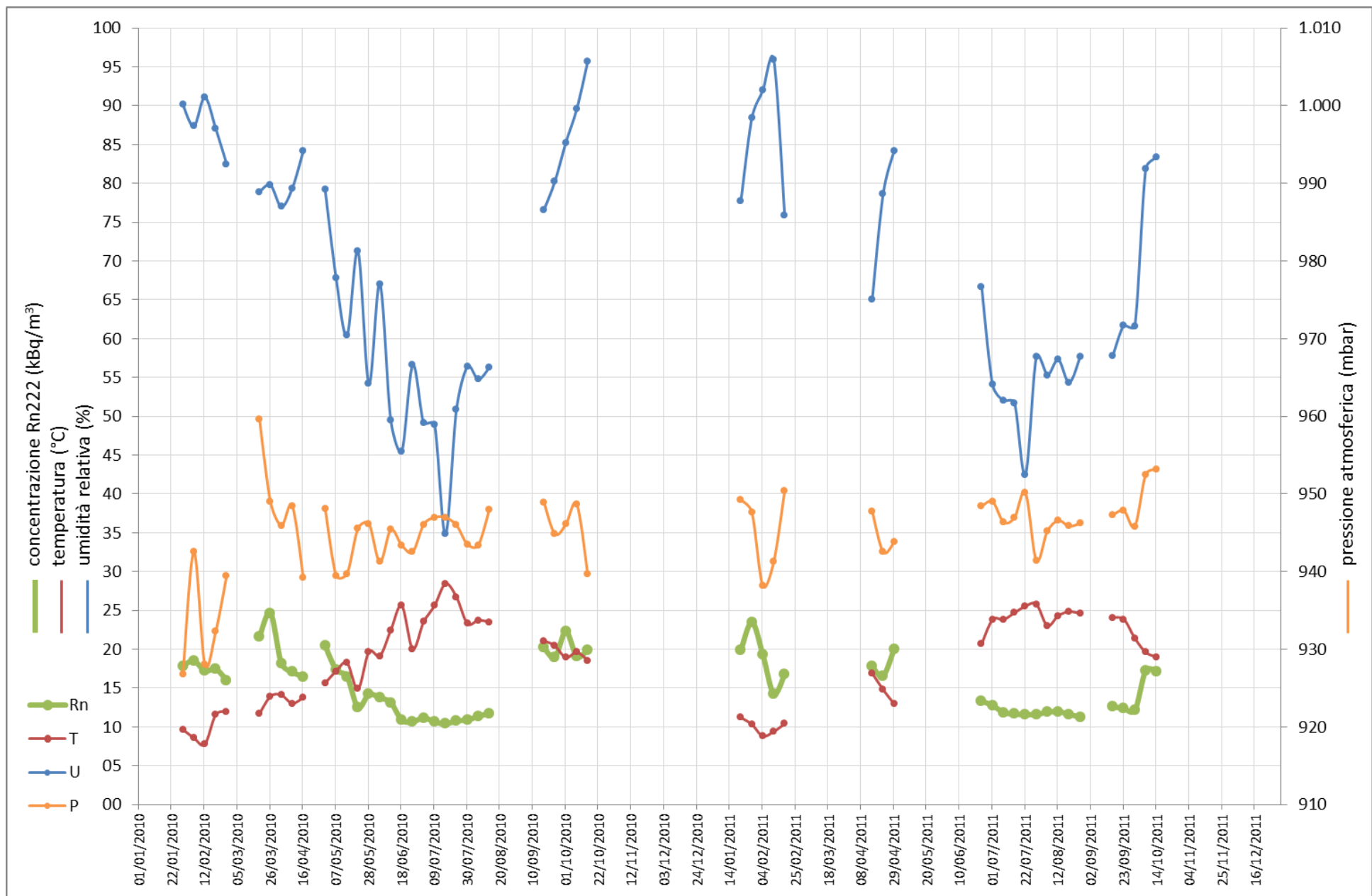
Figura 5 – Dettaglio dei valori settimanali medi di concentrazione di radon, temperatura, umidità relativa e pressione atmosferica registrati dalla stazione di rilevamento di Ragusa nel periodo 2010-2011.
