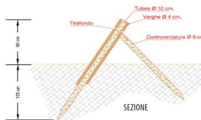
Una seconda barriera, costituita da uno schermo frangivento posto tra la duna e la viminata realizzata con culmi di canna, tenderà di contenere il processo di demolizione della scarpata dunale e di scalzamento degli apparati radicali della copertura vegetale dell'habitat 2250\* *Dune costiere con *Juniperus macrocarpa**.
