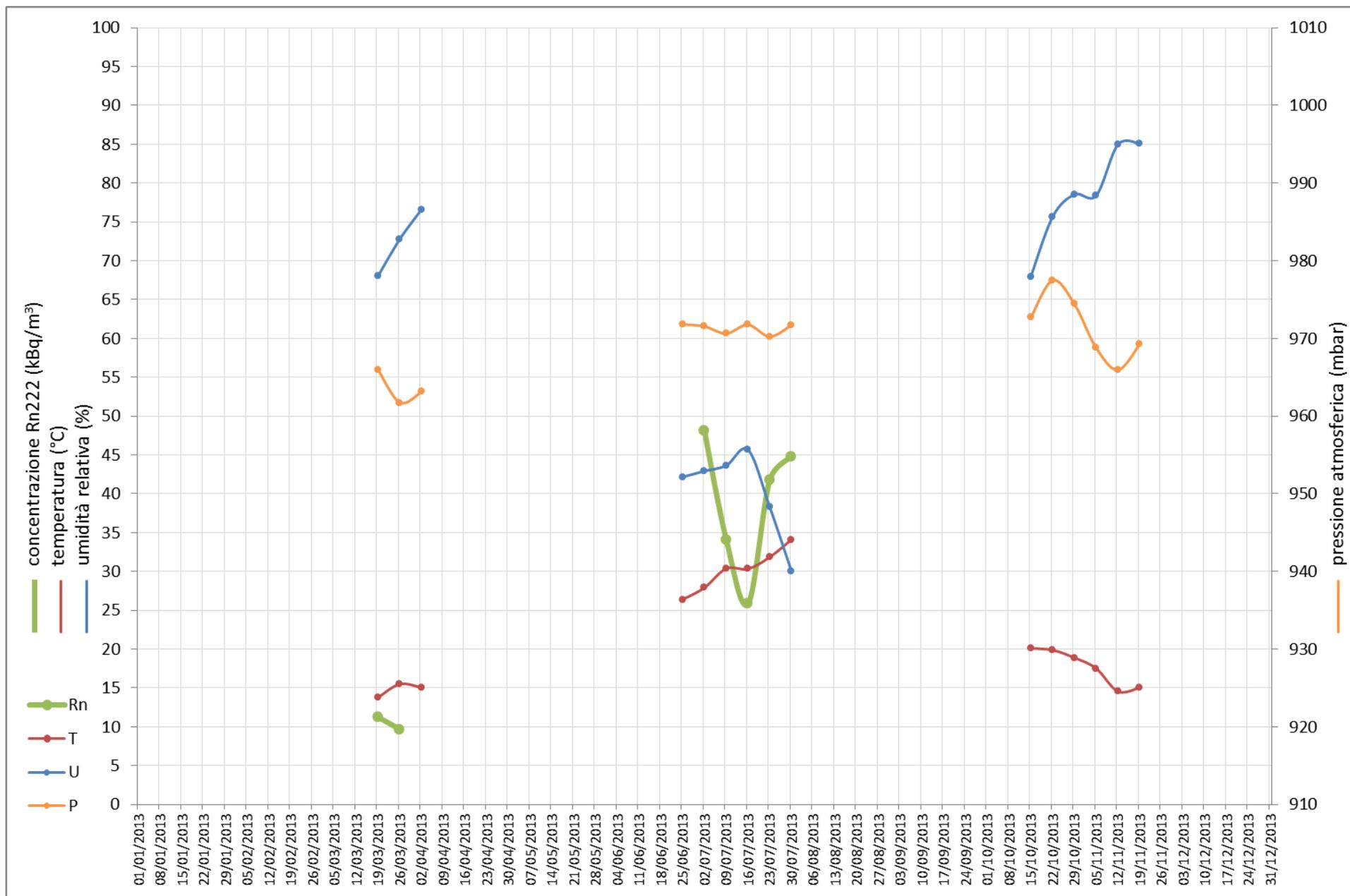
Figura 5 – Grafico dei valori mensili medi di concentrazione di radon, temperatura, umidità relativa e pressione atmosferica registrati dalla stazione di rilevamento di Modica nell'anno 2013.
