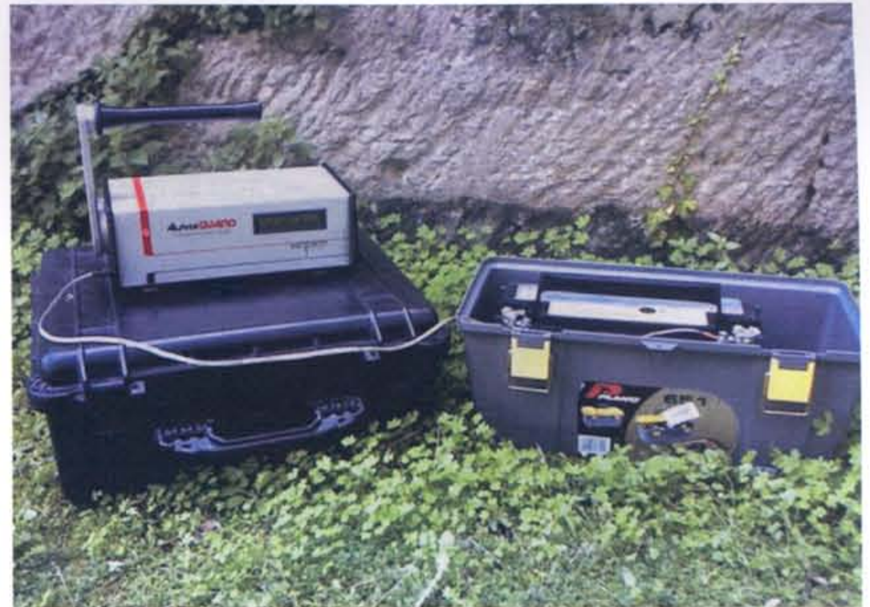
Fig. 6 - Il rivelatore AlphaGUARD PQ2000PRO alimentato da una batteria ad alta capacità.
