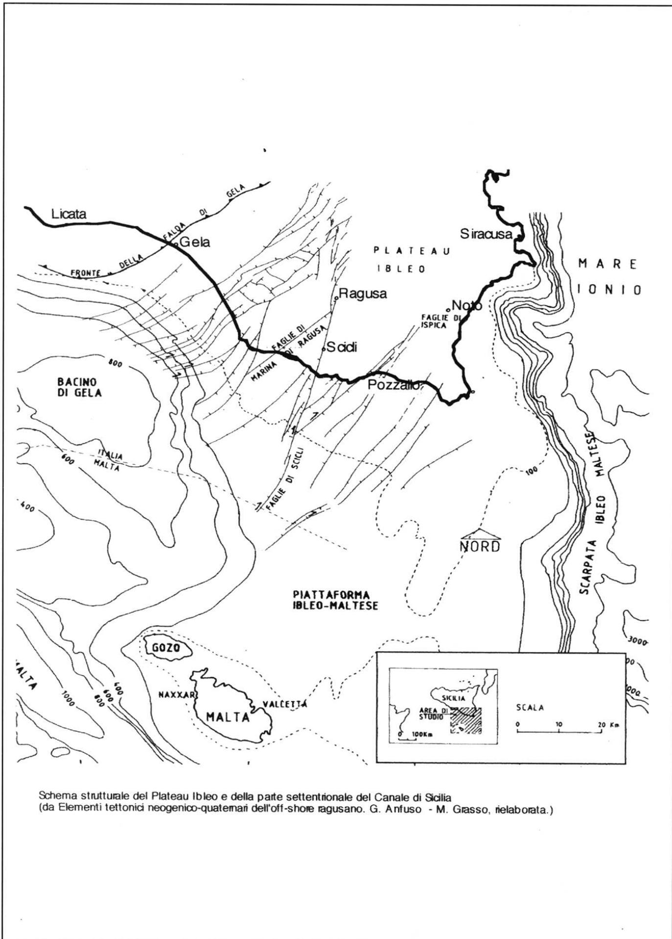
Schema strutturale del Plateau Ibleo e della parte settentrionale del Canale di Sicilia
