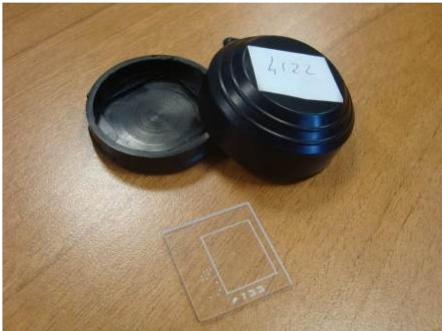
**Figura 1** \_Foto di un rivelatore CR-39 disassemblato.
