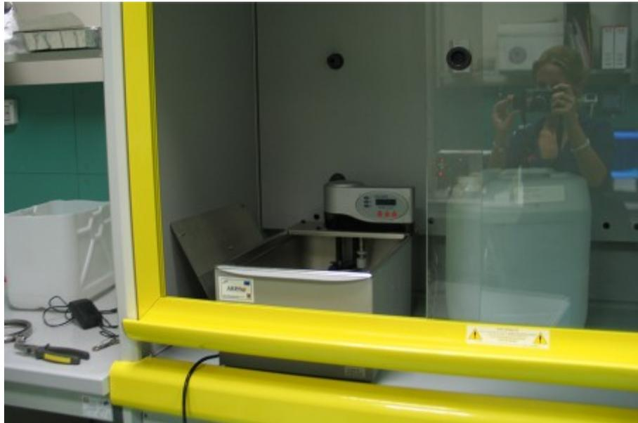
**Figura 8** *Bagno chimico per i dosimetri CR-39.*
