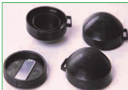
Foto 1 . Rivelatori di radon di tipo passivo.
