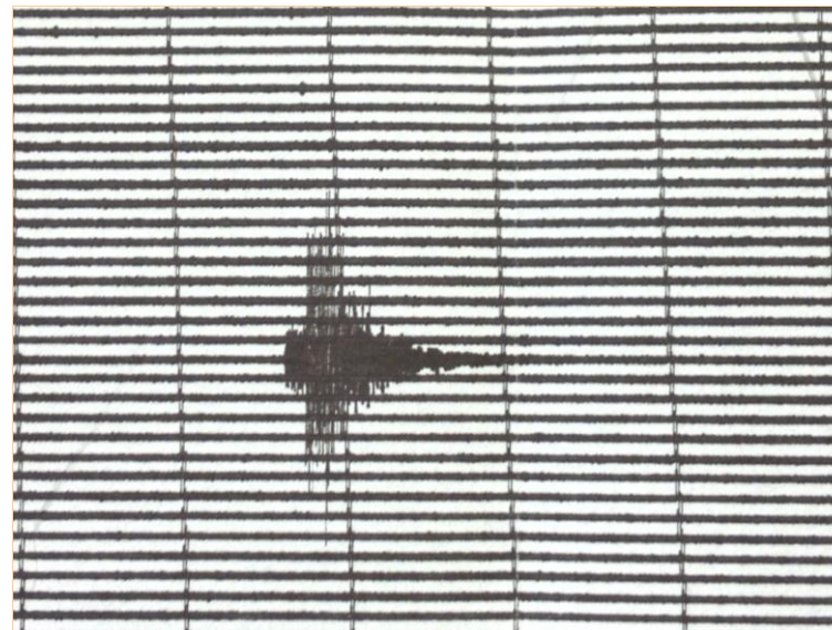
Foto 1 – Sismogramma del terremoto del giorno 08.05.2010 ore 22:23 UTC (M = 3.0), con epicentro al largo di Portopalo di Capo Passero (SR), registrato dal sismografo su carta termica del Centro Elaborazione Dati di Ragusa.
