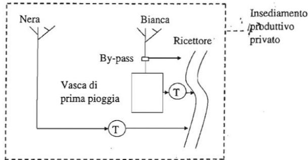
*Schema di vasca di prima pioggia fuori linea di cattura in un insediamento produttivo privato che recapita le acque reflue e quelle meteoriche di dilavamento in un corpo idrico ricettore a seguito del trattamento (T).*
