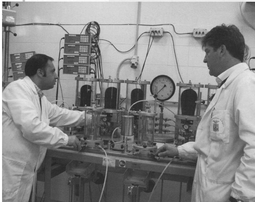
L'apparecchiatura triassiale per terre del laboratorio geotecnico
